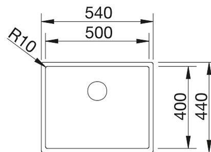
Profondeur de la cuve : 190 mm
