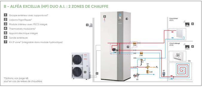
Schémathèques hydrauliques et électriques détaillées présentes dans la notice d'installation.
