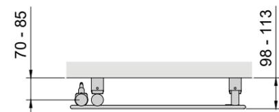
CÂBLE : SORTIE À GAUCHE (LONGUEUR UTILE : 1100 MM)
