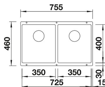
Profondeur de la cuve : 200/200 mm
