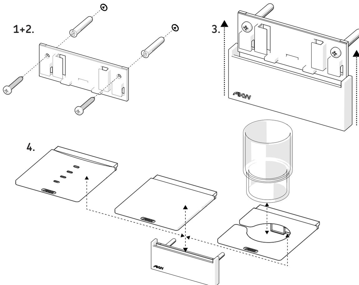
1. Placer le support mural contre le mur. En utilisant un niveau, marquer les positions des trous en vous assurant que le support est horizontal. Percer les trous et insérez les chevilles.
