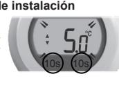
Mientras el ajuste parpadea, toque la zona izquierda para que se muestre el límite de temperatura mínima. También se puede modificar utilizando el aro selector.
