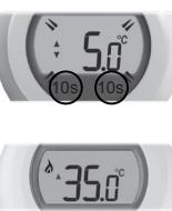
Enquanto este ajuste piscar, toque brevemente na zona de contacto esquerda para mostrar o limite de temperatura mínima. Também pode executar isto com o anel de ajuste.
