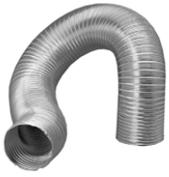
Gaines semi-rigides. Classement: M0. Les gaines GA sont prévues pour les installations VMC, de ventilation d'air froid ou chaud et le raccordement des hottes de cuisines domestiques. Température d'utilisation: -30°C à +250°C.
