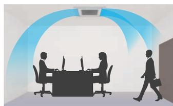
Diffusion d'air confortable en évitant le soufflage direct sur l'occupant.
