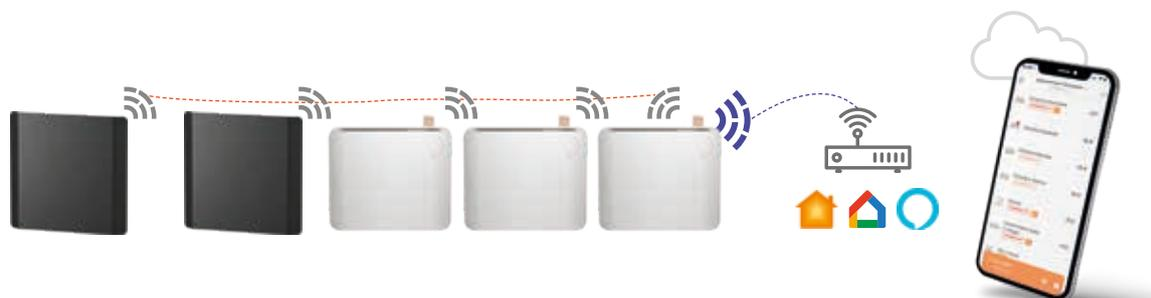
Les radiateurs nativ sont liés par radio fréquence avec les radiateurs équipés d'un module.
