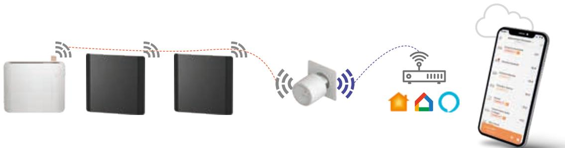
Les radiateurs nativ et les radiateurs avec module sont liés entre eux et à la passerelle intuis connect par radio fréquence.
