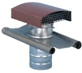
Chapeaux de toiture métalliques. Capot pare pluie en aluminium pré laqué avec grille de protection. Abergement en plomb, manchon de raccordement en acier galvanisé. Conçu pour le rejet ou la prise d'air en toiture. Compatible à tous les systèmes de couverte
