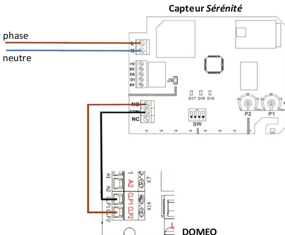
**Option Sans Fil:** En cas d'oubli ou d'impossibilité de raccorder électriquement la sonde au caisson, vous pouvez utiliser des produits radio du marché. Afin de vous orienter nous avons présélectionné deux modèles selon les câblages ci-après:
