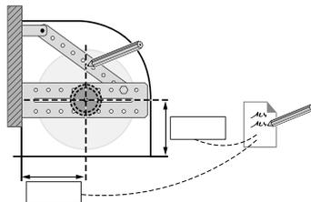
4 Débranchez les fixations du volet, manœuvrez le système d'actionnement dans le sens de la montée pour détendre le ressort de compensation.
