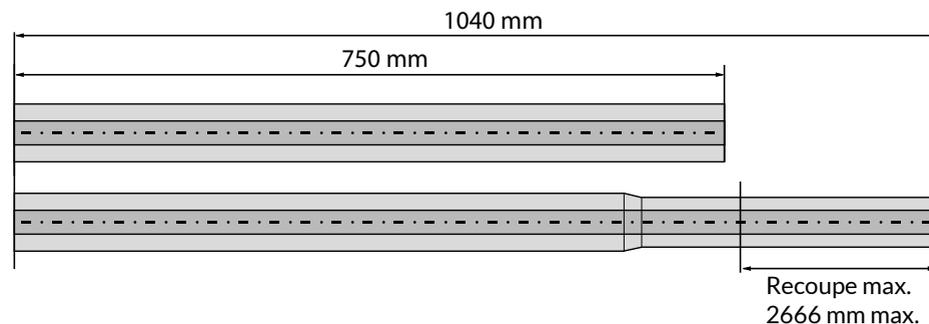
Adaptez la longueur des tubes en fonction des dimensions mesurées
