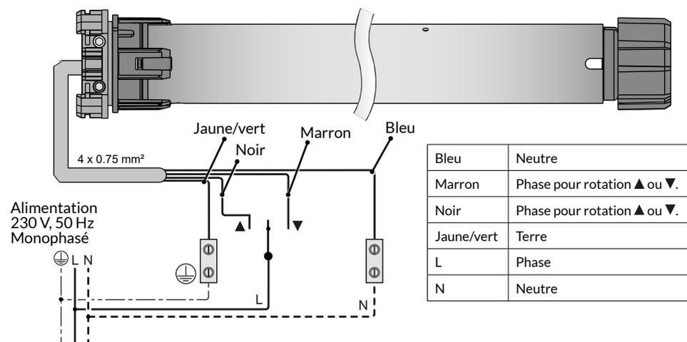
Note : En cas d'inversion des sens montée et descente, permutez les fils marron et noir (▲ et ▼ sur l'inverseur).
