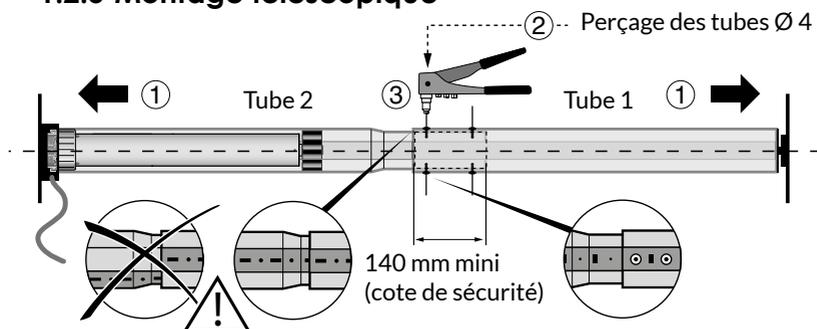
Utilisez impérativement les 4 rivets aveugles fournis pour assembler chaque élément des tubes télescopiques
