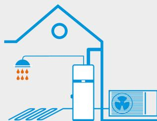
Le Chauffe-Eau Thermodynamique produit l'Eau Chaude Sanitaire grâce à l'énergie captée dans l'air, le reste étant fourni par l'électricité. La production de chauffage/ rafraîchissement est réalisée par une pompe à chaleur.
