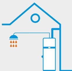
Le Chauffe-Eau Thermodynamique produit l'Eau Chaude Sanitaire grâce à l'énergie captée dans l'air. La production de chauffage/ rafraîchissement est réalisée par l'électricité.
