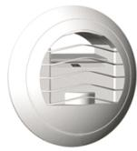
Bouches d'extraction autoreglables. Caractéristiques aérauliques certifiées NF. Installation sur parois, horizontales ou verticales. Grille centrale amovible pour faciliter l'entretien. Fournies sans manchette. Fabrication polystyrène blanc, débit nominal
