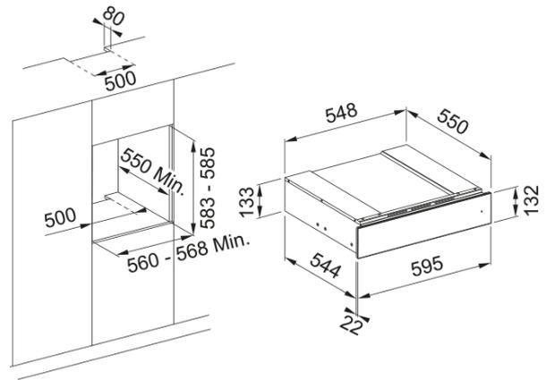
Tiroir chauffant - ouverture push pull - thermostat réglable de 40 à 75 °C - 14 cm - charge jusque 25 Kg - noir
