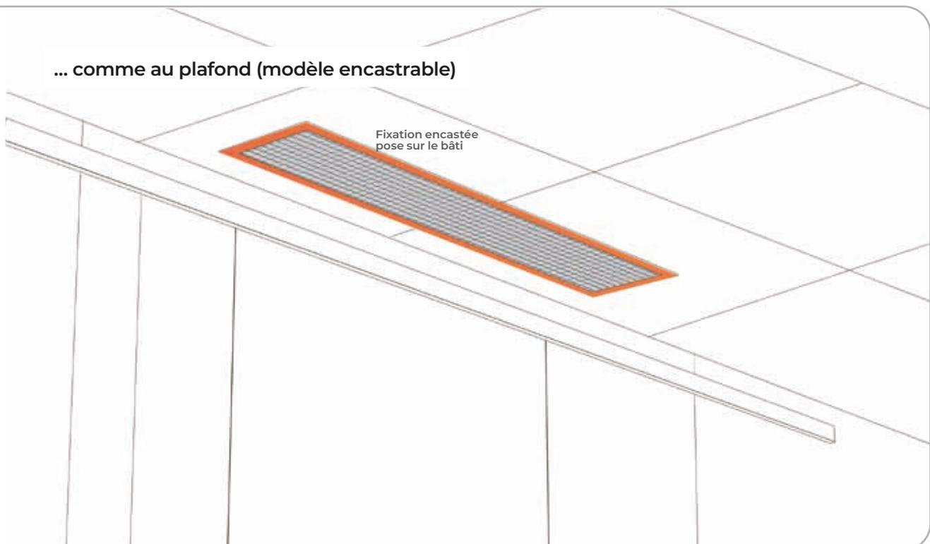
Fixation encastrée pose sur le bâti
