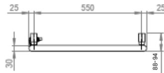
CÂBLE : SORTIE À GAUCHE (LONGUEUR UTILE : 1100 MM)
