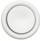
Bouches d'insufflation métalliques réglables. Faible niveau sonore, réglage aisé. Débits de 15 à 500 m<sup>3</sup>/h, fournies avec manchette lisse en acier galvanisé. Fabrication en tôle d'acier et peinture époxy blanche, obturateur mobile réglage par molette excen
