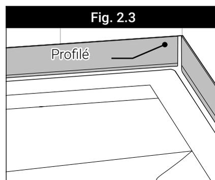
**Etape 2. Fixation murale** - Lorsque les profilés sont posés contre le mur, percez avec des chevilles appropriées dans le mur, puis fixez-les à l'aide de vis en acier inoxydable à tête fraisée (non fournies). Vérifiez à nouveau que le receveur est de niveau et effectuez un test à l'eau avant de poser le revêtement mural. Appliquez du silicone sur le profilé (voir Fig. 2.4).
