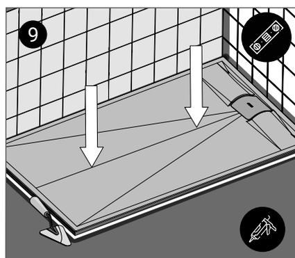
9 Le revêtement de sol doit affleurer les bords du receveur et être scellé à l'aide d'un silicone. Protéger temporairement la bonde pour éviter que des débris y pénètrent pendant l'installation.
