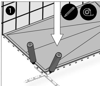
1 Positionnez le receveur sur l'emplacement souhaité pour la douche et le tuyau d'évacuation. Marquez au sol le contour du receveur et de la bonde.
