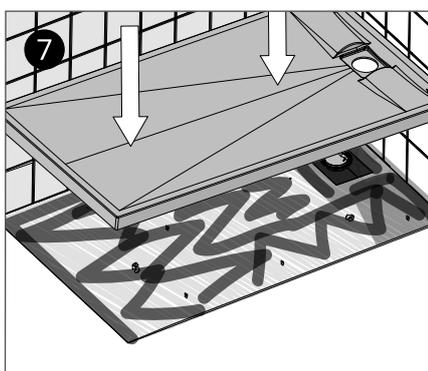
7 Mettez le receveur en position et vérifiez sa hauteur par rapport à la hauteur du sol fini. Fixez fermement le receveur en position et vérifiez que les 4 côtés sont de niveau.
