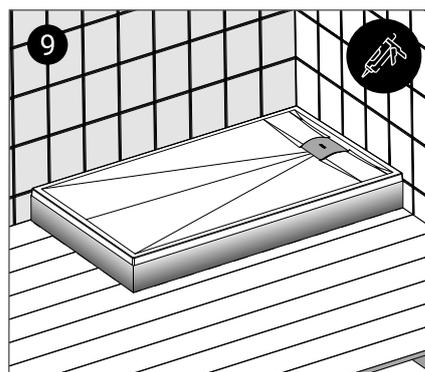
9 Installez le tablier (non compris) sur les bords du receveur et scellez-le avec du mastic d'étanchéité. Couvrez temporairement la bonde pour la protéger des débris qui pourraient y pénétrer pendant l'installation.
