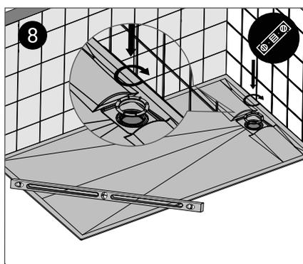
8 Fixez la bonde au bac à l'aide de la bague de serrage (voir les instructions séparées relatives aux bondes). Appliquez un mastic de silicone sur l'ensemble de la zone de douche (voir les instructions du fabricant).
