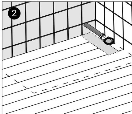
2 Mesurez la zone d'évacuation et installez le siphon et le tuyau d'évacuation.
