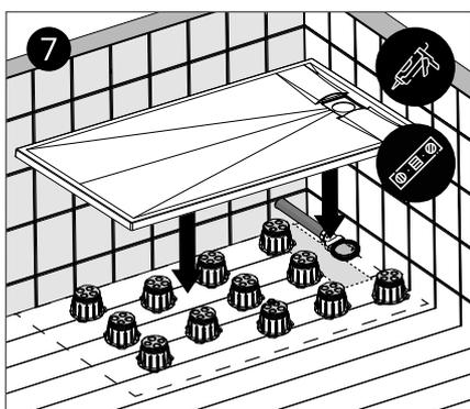
7 Déposez le receveur et fixez-le fermement en position. Vérifiez que les 4 côtés sont de nouveau de niveau.
