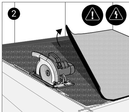
2 Pour une installation encastrée, découpez le sol en prenant soin de ne pas couper les matériaux de soutien, la plomberie ou le câblage électrique.
