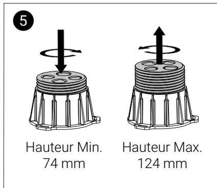
5 Ajustez encore la hauteur des pieds si nécessaire et utilisez un niveau.
