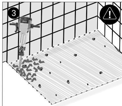
3 Enlevez soigneusement le revêtement de sol en fonction de la hauteur du receveur et du revêtement de sol final. Pour une installation au sol, dégagez le matériau juste autour de la bonde.
