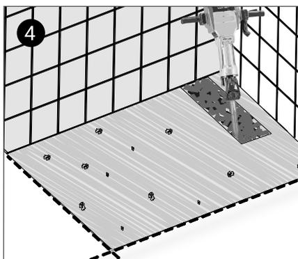
4 Pour une installation encastrée ou au sol, retirez le matériau du sol pour la bonde et dégagez un canal pour le tuyau d'évacuation.
