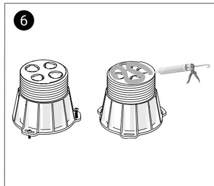
6 Fixez les pieds au sol à l'aide de vis et appliquez de l'adhésif sur la face supérieure avant de positionner le receveur dessus.
