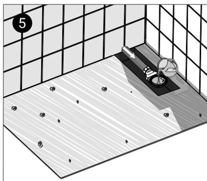
5 Installez le tuyau et le siphon. Effectuez un test à l'eau pour vérifier l'écoulement des eaux usées et l'absence de fuites. Assurez-vous que le joint en caoutchouc est en place sur le dessus du siphon. Vérifiez la position de la bonde avec le receveur.
