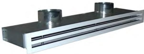
Diffuseurs linéaires aluminium à fentes (1 à 8), à jets d'air orientables, utilisables en extraction ou soufflage, finition alu anodisé ou peinture blanche (RAL 9016).
