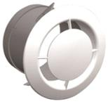
Bouches d'extraction plastiques. Esthétique, faible niveau sonore, installation sur cloison mince ou dalle. Fabrication polystyrène blanc, gabarit de positionnement intégré à la manchette. Fournie avec manchette: à griffes pour placo, longues pour travers
