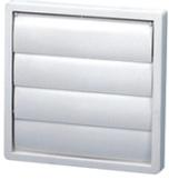
Volets de surpression aluminium, encastrable de section rectangulaire ou carrée. Cadre et ailettes en aluminium anodisé. Axes des ailettes en acier montés sur des paliers PVC. Existe en prise d'air vers l'intérieur (volets inversés) sur demande. Destinés
