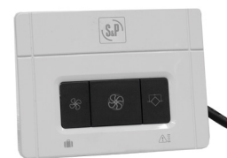
Commande déportée avec câble (1,5 m inclus) Fonctions de la commande déportée • Marche/Arrêt • Sélection des vitesses (3 vitesses) • Passage manuel du By-Pass • Alarme de filtres encrassés
