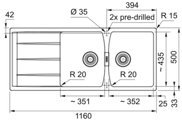
Evier CENTRO, CNG 621 Gris Ardoise, à encastrer 1160x500 mm. Sa matière Fraganite résiste aux rayures, aux chocs et aux taches. Vidage automatique, Trop plein design inox avec sa bonde et son bouton rotatif. Tous ces accessoires qui permettent une installation en toute tranquillité.
