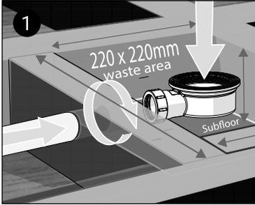
(1) Placez d'abord le receveur de douche à l'emplacement désiré et déterminez la position, la profondeur et le dégagement requis pour la bonde et les évacuations avec au moins une pente d'un centimètre par mètre. Assurez-vous qu'il y a suffisamment de soutien autour de la bonde (voir instructions séparées du receveur).
