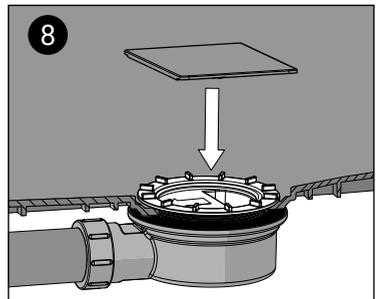
(8) Positionnez le couvercle de la bonde. Protégez le siphon des débris pendant l'installation.
