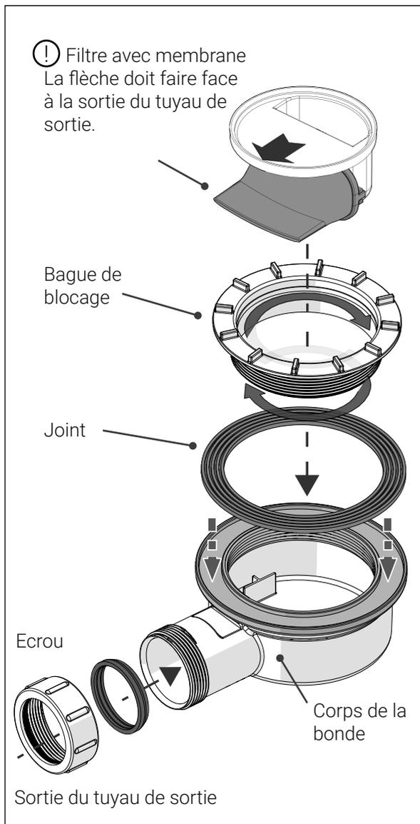
Les bodes AKW sont conçues pour un faible entretien et un fonctionnement fiable. Le filtre avec membrane est situé à l'intérieur de la bode et doit être vérifié dans le cadre d'un programme d'entretien planifié.
