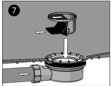
(7) Insérez le filtre avec membrane dans le corps de la bonde, en veillant à ce que la membrane soit orientée vers le tuyau d'évacuation avant de positionner le couvercle de la bonde.
