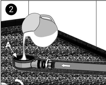
(2) Avant d'ajuster la bonde, placez l'écrou sur le tuyau d'évacuation, suivi de l'anneau de support et du joint d'étanchéité. Insérez le tuyau d'évacuation dans la bonde et serrez l'écrou. Vérifiez que la connexion du tuyau est correctement assemblée, scellée et étanche en versant un peu d'eau. Assurez-vous que le joint d'étanchéité de la bague de blocage (A) est placé dans la section haute du corps de la bonde avant de la connecter au receveur.
