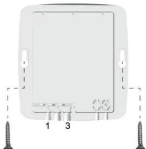
4. Conecte el cableado de la puerta de enlace.
