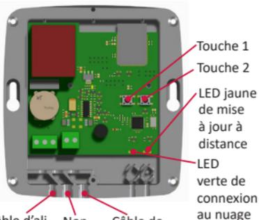
Câble d'alimentation Non utilisée Câble de connexion H-LINK
