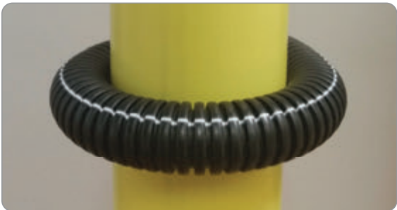
Le conduit semi-rigide est testé selon la norme EN 61386-1/-24 pour vérifier la flexion et est soumis à des essais de flexion sous contrainte à haute et basse température.
