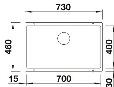
Profondeur de la cuve : 190 mm
