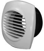
Bouches d'extraction plastiques. Esthétique, faible niveau sonore, installation sur cloison mince ou dalle. Fabrication polystyrène blanc, gabarit de positionnement intégré à la manchette. Fournie avec manchette: à griffes pour placo, longues pour travers
