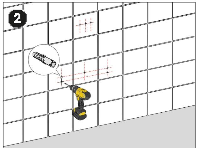
2 Vérifiez la présence de câbles et de canalisations avant de percer. Percez les trous à l'aide d'un foret approprié pour murs et carreaux et insérez les chevilles.
