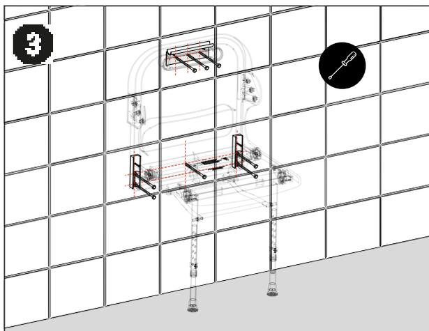
3 Utilisez des fixations murales appropriées pour fixer les supports de montage au mur. N'utilisez pas de vis à tête fraisée.
