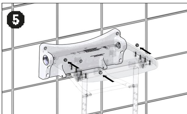
5 Le siège 2030 comprend des bouchons à vis qui doivent être insérés en dernier lieu dans les trous de vis du haut et du milieu, comme illustré sur l'image de gauche.
