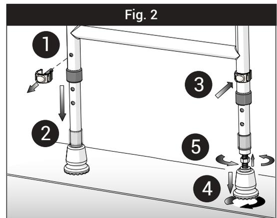
Une fois le siège fixé au mur, procédez à la mise au point du pied. Faites glisser le couvercle sur la partie intérieure du pied. Retirez l'écrou de la partie intérieure du pied, puis déroulez le pied. Mettez l'écrou en place, puis enrroulez le pied jusqu'à ce que l'écrou vienne buter contre le pied intérieur. Les deux pieds doivent être fermement posés sur le sol, c'est-à-dire que l'un d'eux ne doit pas être à peine touché.
