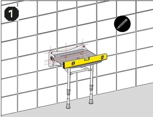
1 Marquez la position souhaitée des supports de montage sur le mur en vous assurant que le siège est de niveau. Ajustez les pieds pour effectuer un réglage plus fin.
