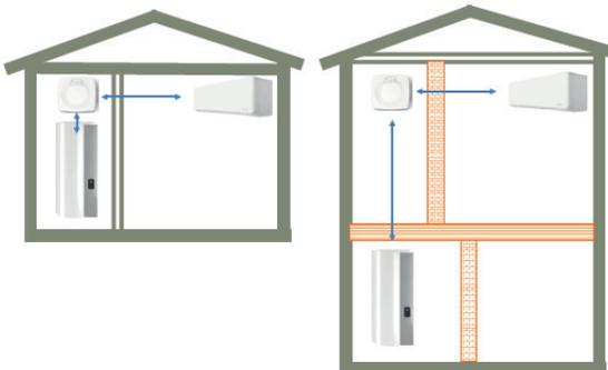
Dans le cas où le chauffe-eau est séparé de l'unité intérieure par une cloison plus dense qu'une plaque de plâtre, il faut positionner le Hub comme un répéteur, c'est-à-dire, prenant en compte l'atténuation du signal radio.
