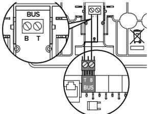
Diagrama de ligação ao sistema. Um círculo destacado mostra o terminal 'BUS' com os fios 'B' e 'T' conectados. Outro círculo destacado mostra o conector 'BUS' da interface de sistema. |
