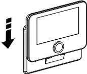
Ilustração de um dispositivo sendo empurrado para baixo na placa de base, com uma seta indicando a direção.                                                                               |
