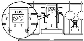
Diagrama de instalação na parede. Um círculo destacado mostra o terminal 'BUS' com os fios 'B' e 'T' conectados.                                                                          |
