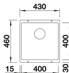
Profondeur de la cuve : 190 mm
