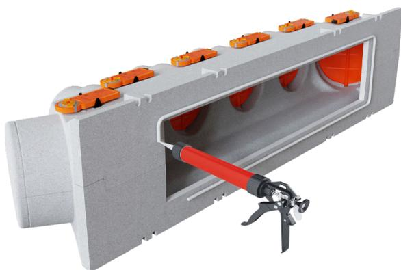
Nous conseillons l'utilisation d'un cordon de silicone en périphérie de la découpe avant de l'appliquer contre l'évaporateur et assurer ainsi une parfaite étanchéité de paire avec la bande aluminium.
