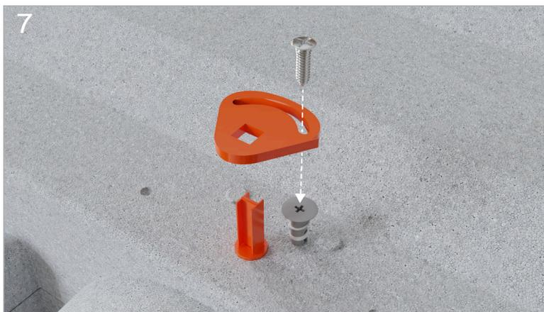
Dans le cas d'un volet manuel vissez d'abord une cheville en nylon puis insérez le palier de guidage manuel et enfin la vis de serrage.
