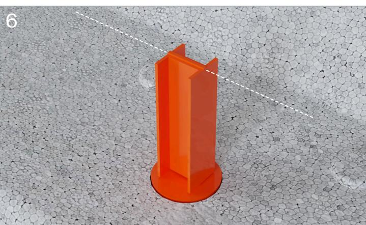
Notez que la partie supérieure de l'axe du volet vous donne l'indication sur la position (ouvert ou fermé) du volet à l'intérieur du plénum. Dans le cas précis les volets sont fermés.
