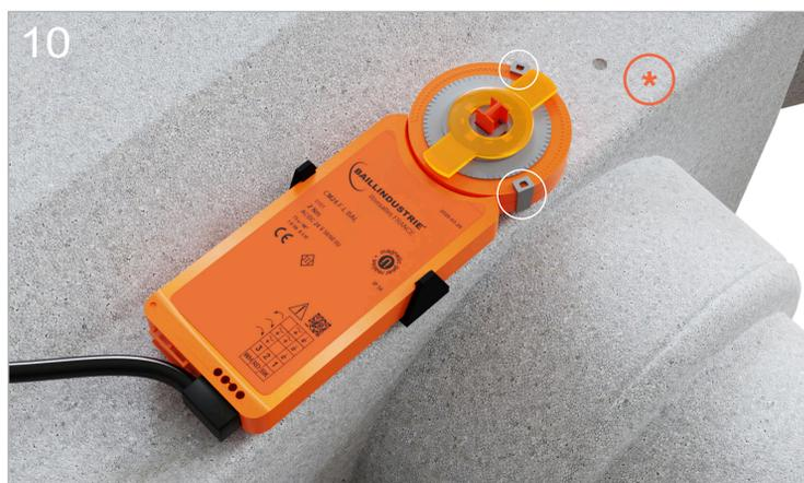
Enfin, clipsez le servomoteur dans la pince en veillant au placement des butées d'ouverture et de fermeture en fonction de l'axe du volet.
