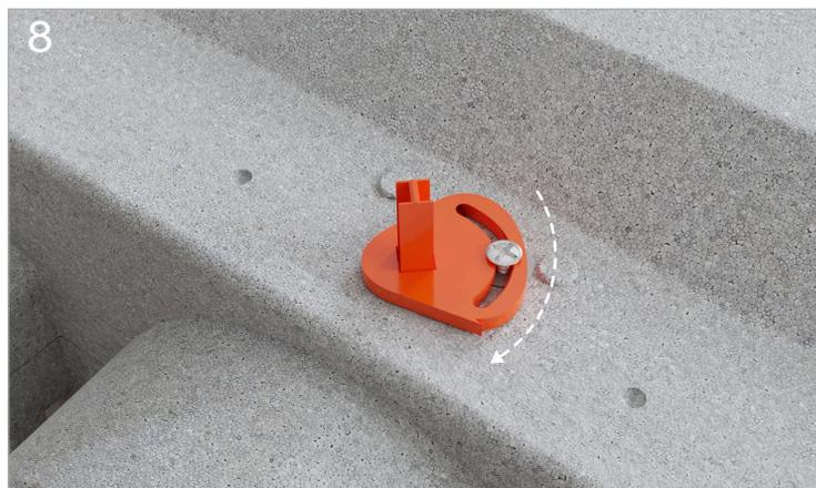
Faites pivoter le palier de guidage manuel selon le degré d'ouverture (débit nominal) souhaité puis serrez la vis pour bloquer l'axe.
