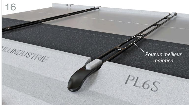
Utilisez les ergots afin de bien tendre les élastomères de fixation et ainsi lier les plénums de soufflage et de reprise.
