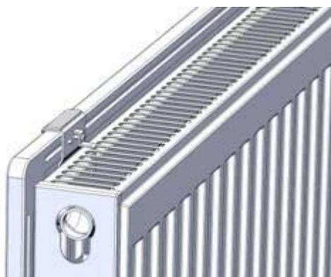
Si le/s crochet/s de fixation de/s agrafe/s ne coïncident pas avec la grille du panneau, il faudra desserrer les vis allen et les déplacer jusqu'à son ajustement.
