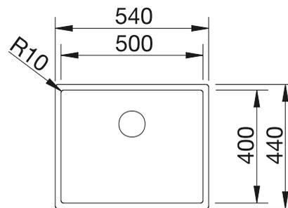
Profondeur de la cuve : 190 mm
