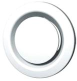
Bouches d'extraction et d'insufflation plastiques réglables. Faible niveau sonore, extraction et insufflation. Débits de 10 à 330m<sup>3</sup>/h. Fabrication polystyrène blanc, obturateur mobile réglage par vis centrale. Écrou de serrage, plage de pression: 40 à 150
