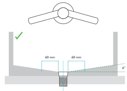
Un angle minimum de 6° au fond de la vasque à partir du siphon permettra un bon écoulement de l'eau et une réduction des risques d'éclaboussures. (Sur un rayon minimum de 60mm)
