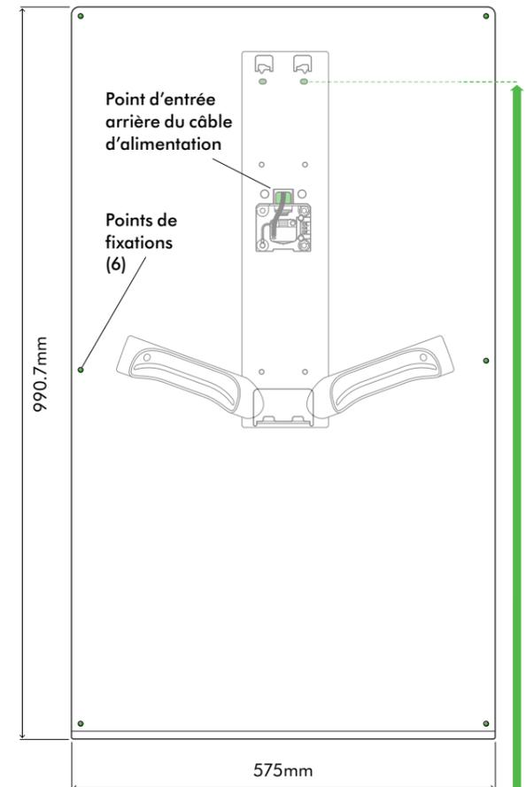
Lorsque seules des plaques de plâtre non supportées sont disponibles pour l'installation, un panneau mural Dyson doit être utilisé.
