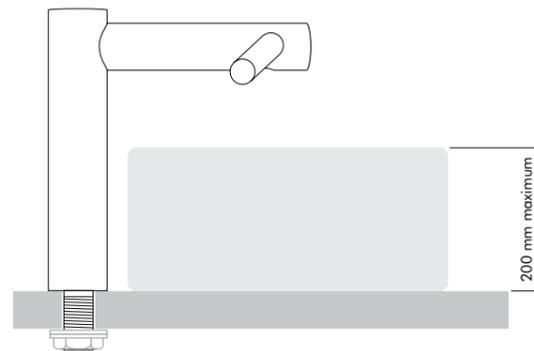
**Fig.3** Distance minimale du centre du robinet au haut de la vasque (seulement pour le WD06) : 100mm. Distance minimale du bord avant de la vasque (pour tous les modèles : sur pied, encastré ou posé) au mur : 385mm.
