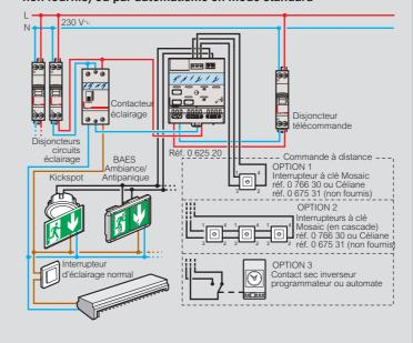
Mise au repos automatique des blocs en cas de coupure de l'éclairage par programmateur horaire ou automate en mode standard
