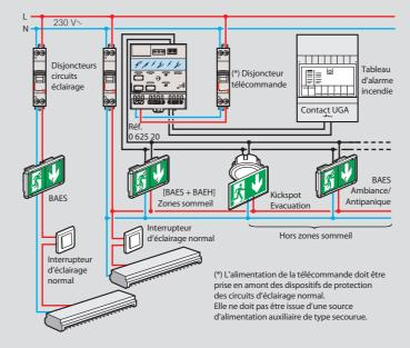
Coupure de l'éclairage et mise au repos des blocs à distance avec interrupteur à clé (Mosaic réf. 0 766 30 ou Céliane réf. 0 675 31 non fournis) ou par automatisme en mode standard
