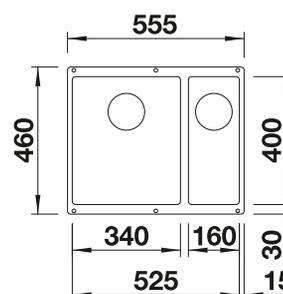
Profondeur de la cuve : 190/130 mm
