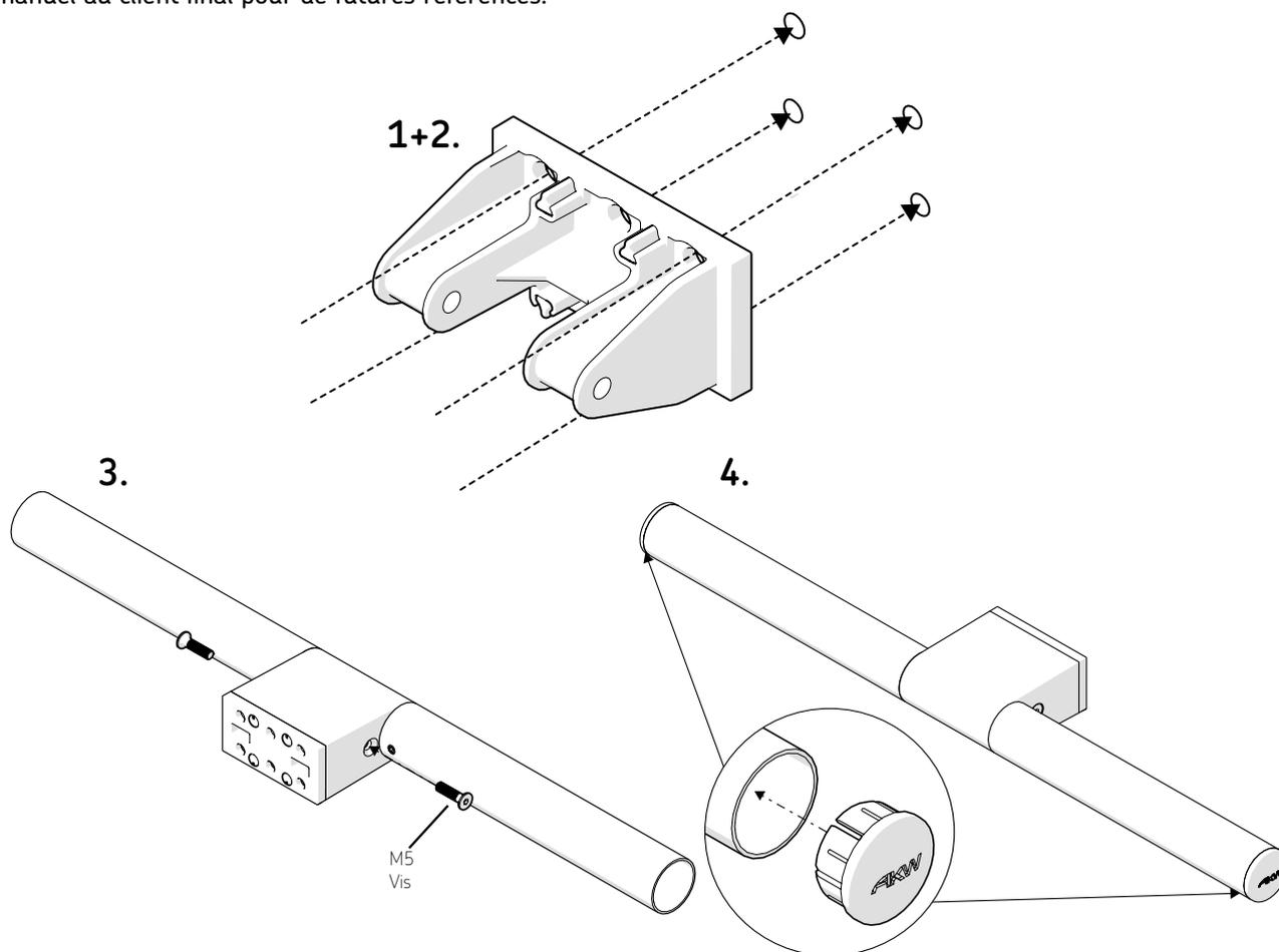
1. Placer le support mural contre le mur. En utilisant un niveau, marquer les positions des trous en vous assurant que le support est horizontal. Percer les trous et insérez les chevilles.
