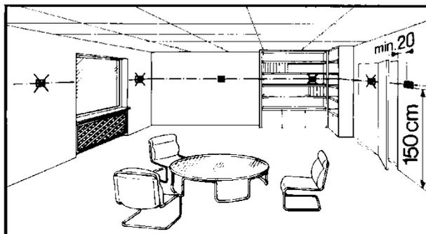
L'appareil peut être fixé sur la plupart des prises encastrées du commerce ou directement sur le mur.
