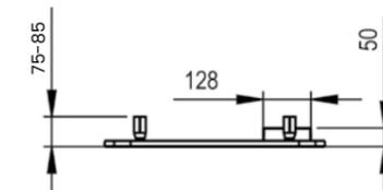
CÂBLE : SORTIE À DROITE (LONGUEUR UTILE : 1100 MM)
