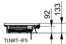
CÂBLE : SORTIE À DROITE (LONGUEUR UTILE : 1200 MM)
