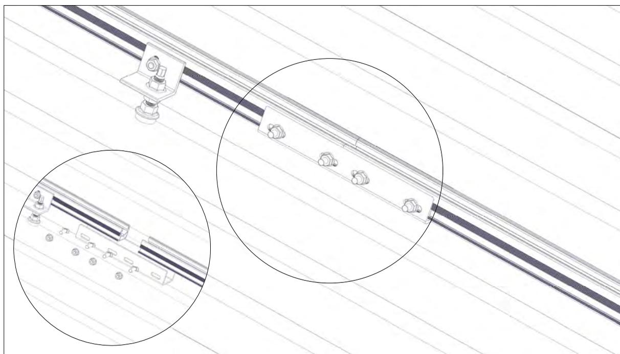
5 Fixation des modules [couple de serrage 14Nm]
