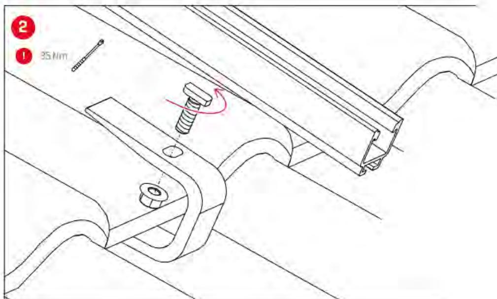
Crochet ardoise [1000373] avec SolidRail ou SingleRail et kit L-Adapter
