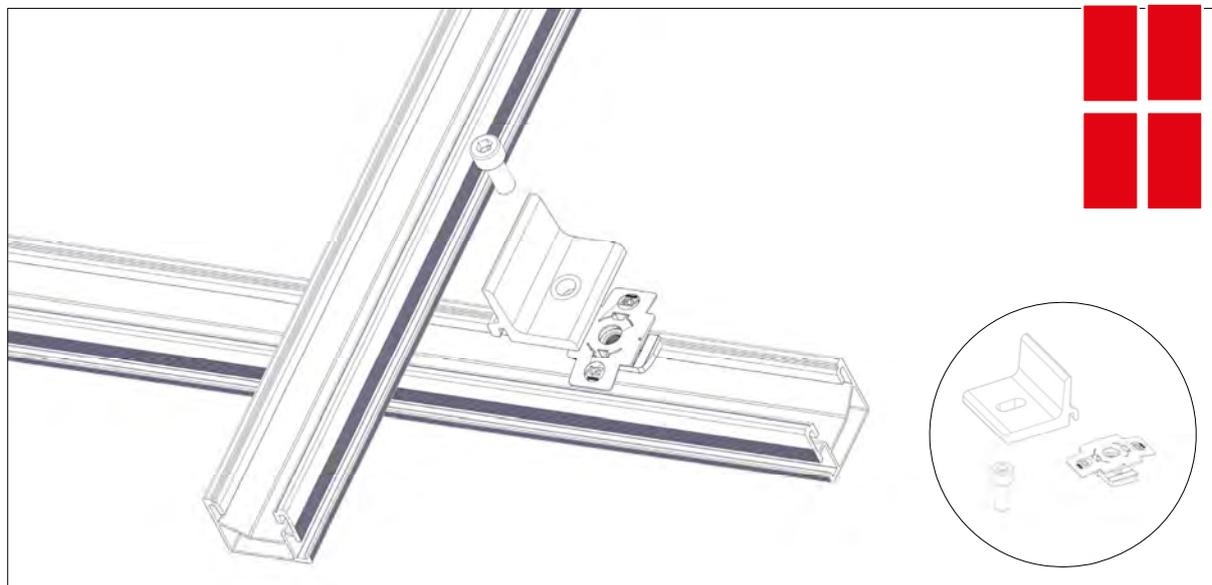
4 Montage des kits connecteurs de rails [couple de serrage 35Nm]
