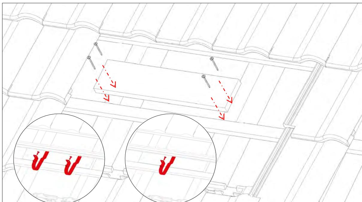
4 Montage des connecteurs de rails (couple de serrage des vis 35Nm)
