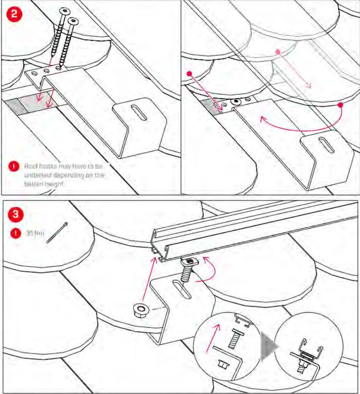
Crochet tuiles plates [1000214] avec SolidRail
