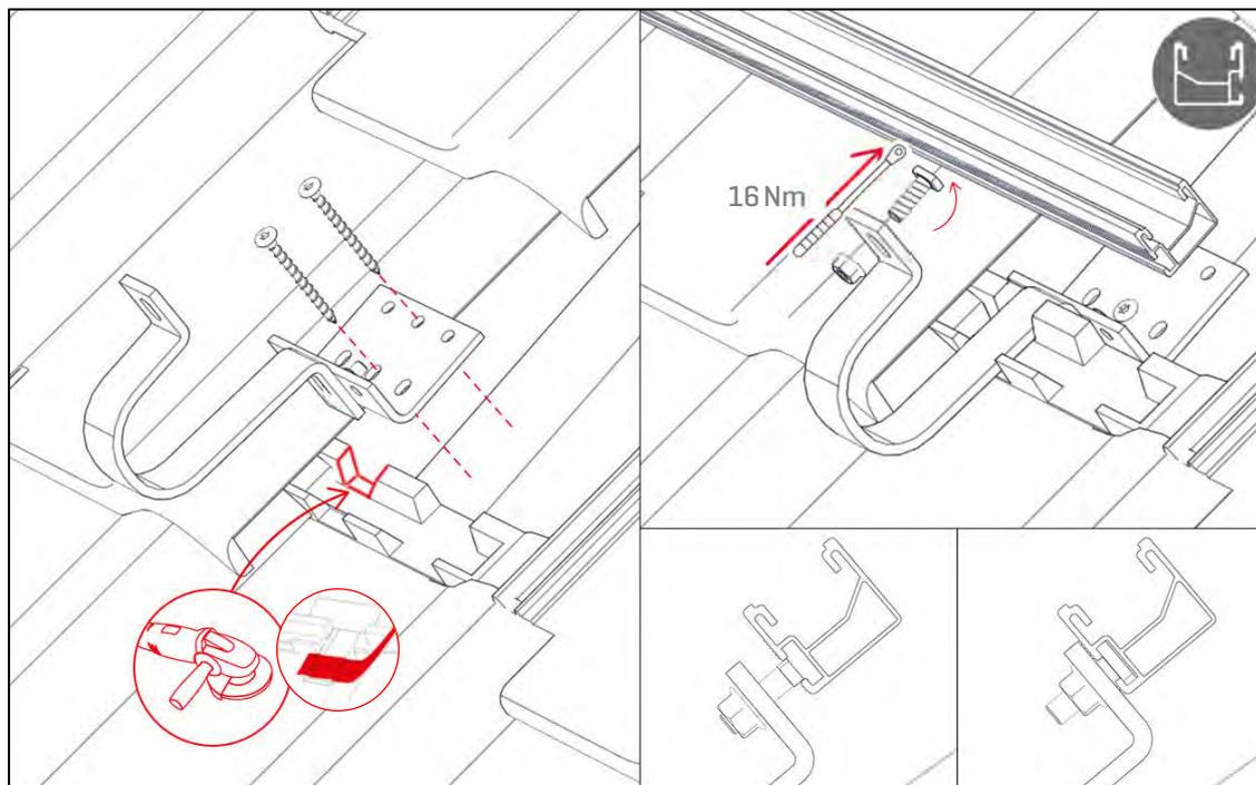
Un complément d'étanchéité doit être ajouté [cf. n°11 « Composants »]
