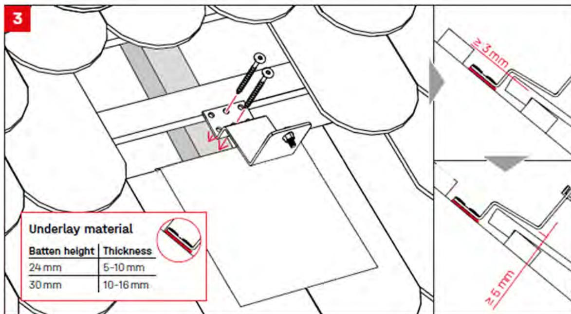
4 Pose de la seconde couche SingleHook FlatTile metal sheet et repositionnement des tuiles
