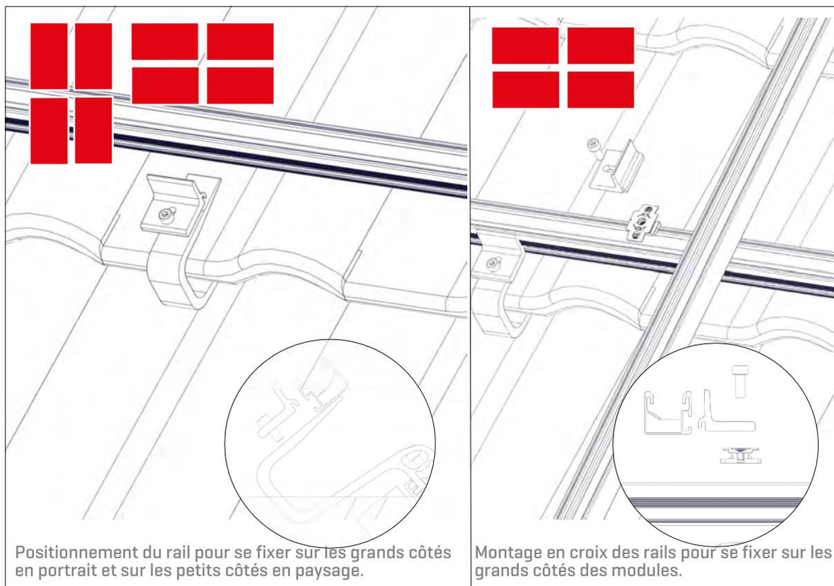
B: Pose de rail en montage vertical avec adaptateur SR fixé sur le SingleHook 3S/4S et avec vis à tête marteau pour fixer le SolidRail directement sur le SolidHook 3S+/4S+
