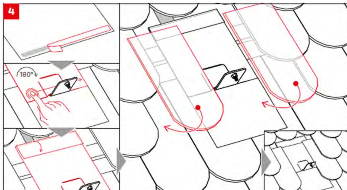
5 Repositionnement des tuiles supérieures au besoin
