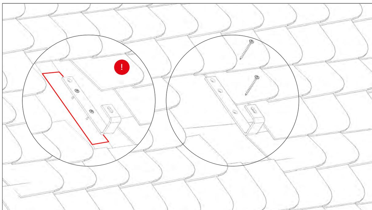
Remarque : dans le cadre de fixation sur des voliges (planches ep 27mm), l'utilisation des vis Paneltwistec de Eurotec est proscrite, du fait que le filetage n'est que partiel (et ne permet pas l'ancrage des platines de crochets)
