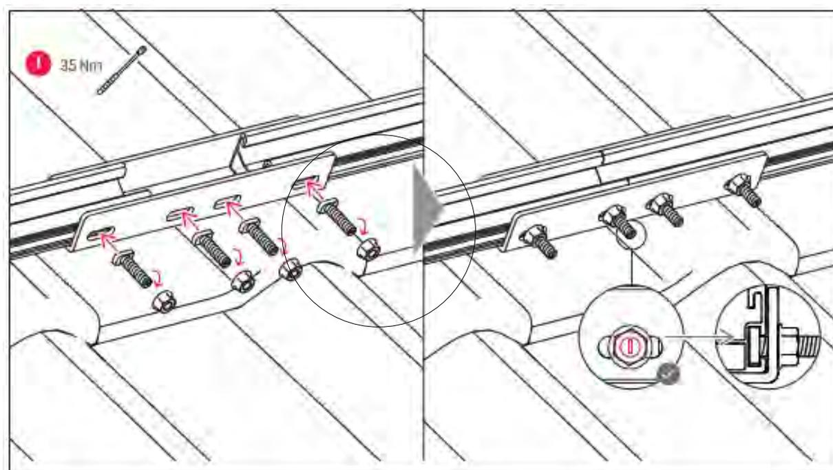
5 Fixation des modules (14Nm)
