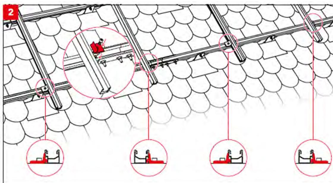
3 Connection des rails => serrer les écrous à 16 N.m
