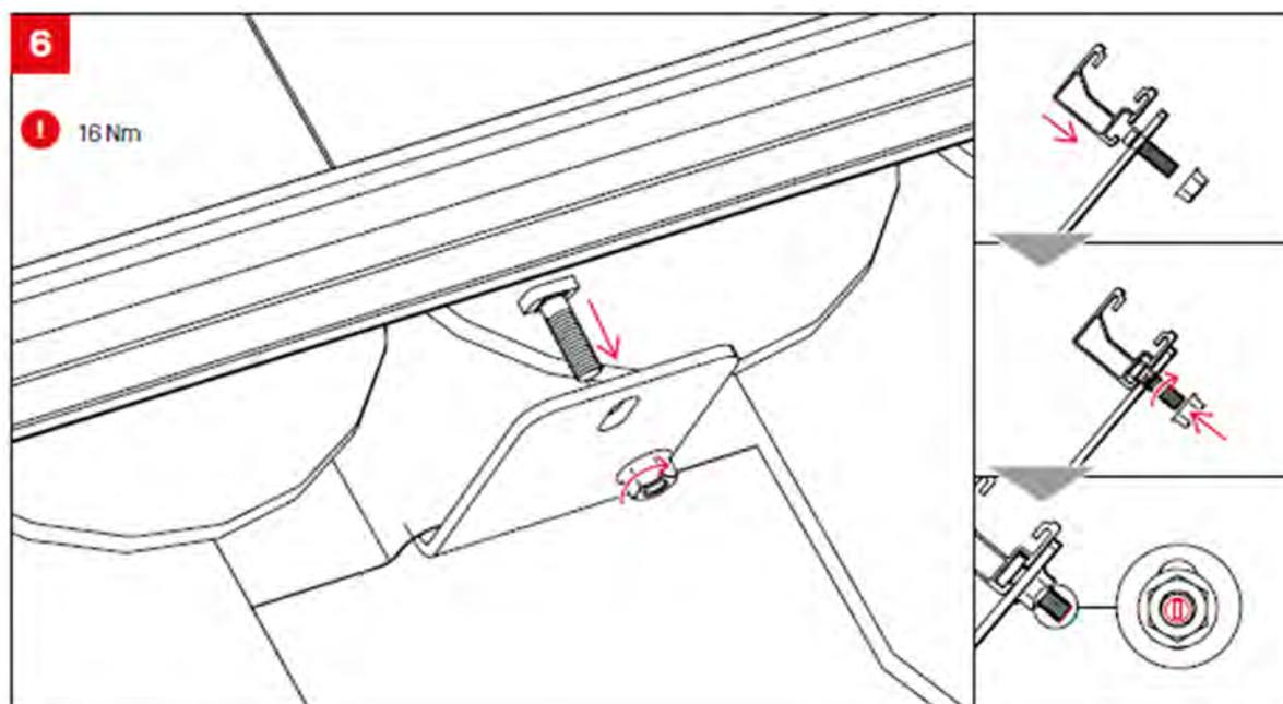
7 Connection des rails => serrer les écrous à 16 N.m
