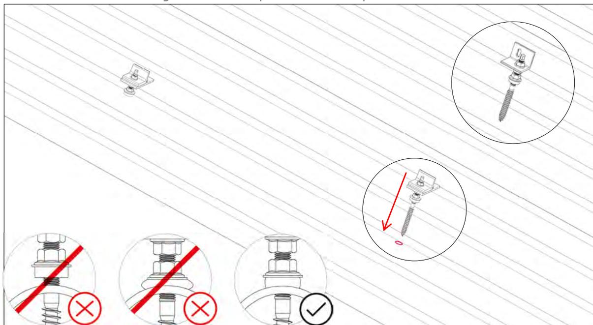
3 Connecter le rail du montage à la vis à double filetage avec le Climber ou l'adaptateur SR
