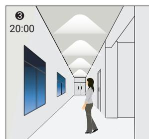
Lorsqu'un mouvement est détecté, la lumière s'allume au niveau de luminosité du temps de maintien.
