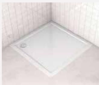
La faible épaisseur de 35 mm permet au receveur d'être encastré dans le sol pour que la surface supérieure du receveur soit au niveau du sol. Le rebord permet toujours une bonne rétention d'eau ce qui évite les débordements, en particulier lorsqu'il est combiné avec la bonde d'évacuation gros débit Vortex auto-nettoyant (qui retire jusqu'à 30 litres d'eau par minute).
