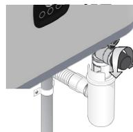
Wanneer u ziet dat er een lek is, probeer dan of het helpt om de aansluitingen aan te draaien. Blijft het lek bestaan, laat de boiler dan leeglopen (zie pagina 49) en voer de aansluitingen opnieuw uit. Voer de aansluitprocedure opnieuw uit totdat het systeem volledig waterdicht is.
