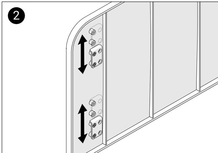
Un réglage supplémentaire de la hauteur peut être effectué en ajustant les supports d'assise sur le dossier.
