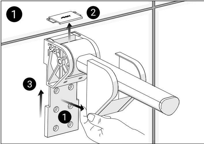
Retirez délicatement les couvercles en les soulevant par le bas. Retirez le couvercle supérieur et soulevez le bras du support pour accéder à la plaque de montage.
