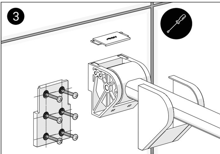
Fixez la plaque de montage au mur à l'aide de fixations murales appropriées. Capacité de charge maximale de 90 kg.
