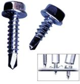
Fixation d'accessoires galva. Vis à tête bombée avec empreinte carrée autoperceuse. Acier galvanisé. Diamètre 4,2 mm, longueur 13 mm ou 19 mm. Livrées en boîte de 1000, avec empreinte adéquate.
